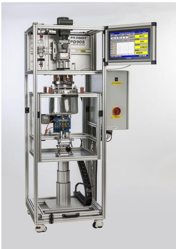
Система разработана для загрузки 1 – 2 L материала. Битум нагревают до 300 °С в сосуде из нержавеющей стали (1.4571) и обрабатывают изотермически сжатым воздухом. Сжатый воздух впрыскивается с помощью трубки с заранее определенной скоростью потока, при этом битум интенсивно перемешивают в сосуде с помощью механической мешалки высокой производительности.
