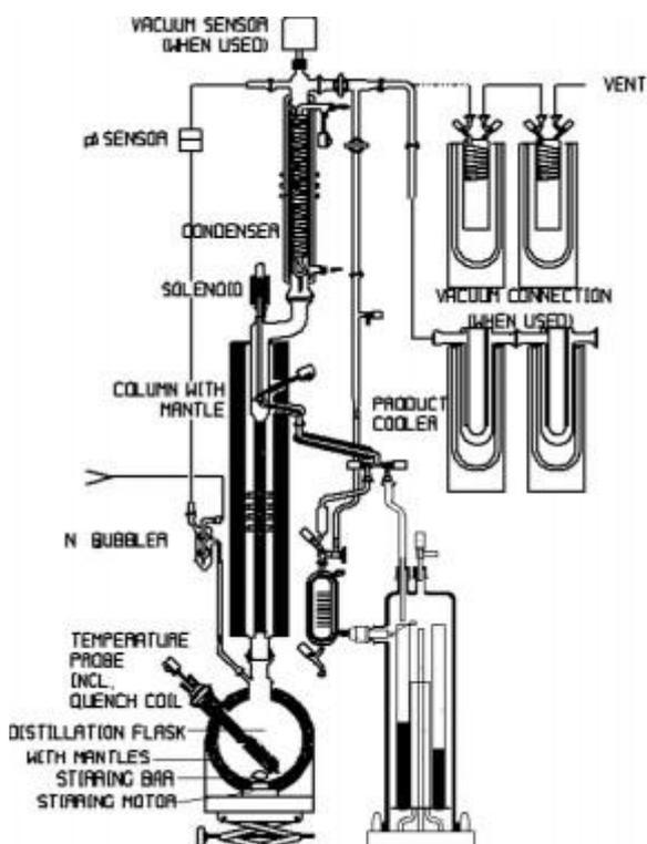
Компьютер управляемая система перегонки сырой нефти для полуавтоматической работы в соответствии с ASTM D-2892.
