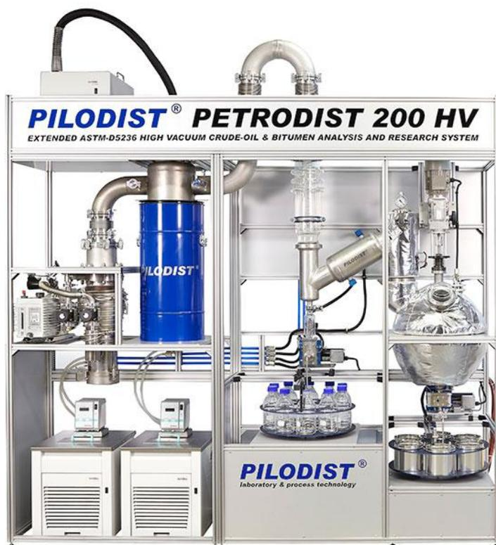
Процессор управляемая система перегонки сырой нефти для автоматического режима работы согласно ASTM D-5236 для дистилляции до конечной температуры 600 ° C АЕТ.
