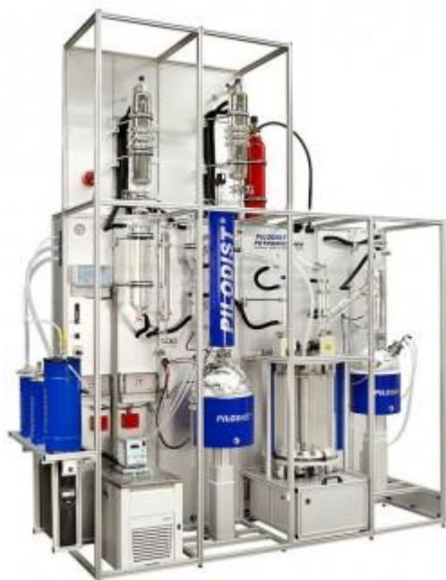
Комбинированная система перегонки сырой нефти для автоматического режима работы в соответствии с ASTM D-2892 (TBP) и ASTM D-5236 (Potstill).
