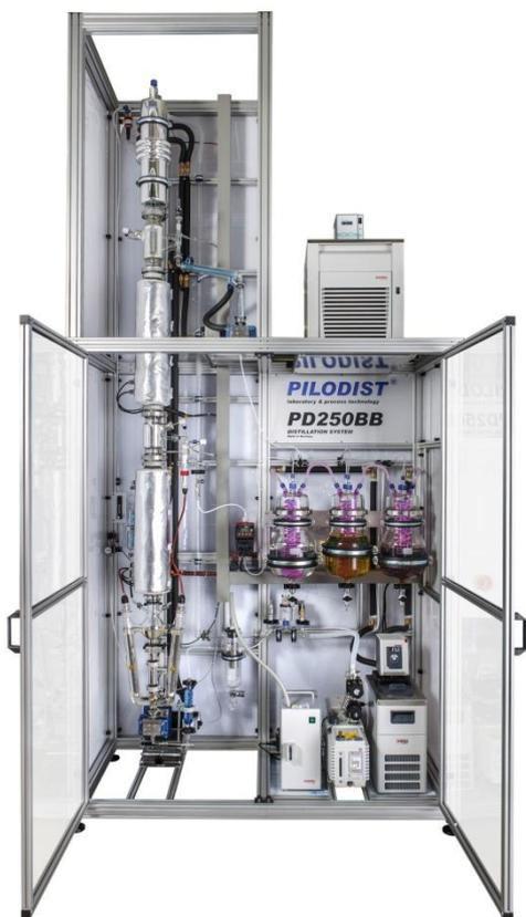
Эта система, изготовлена из высококачественной боросиликатной стеклянной посуды 3.3 для универсальной эксплуатации в атмосферных условиях или в вакууме. Система состоит из 2-х перегонных колонн размером DN 50 с посеребренным покрытием, упакованная в высокоэффективную SULZER-упаковку, чтобы обеспечить высокую эффективность разделения. PILODIST 250 BB оснащен полностью непрерывной системой баланса для всех приемных сосудов (сырье, дистиллят, нижний продукт).
