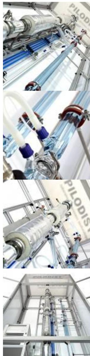
Система была разработана для работы в атмосферных условиях, а также в условиях вакуума до 1 (мм.рт.ст.) в непрерывных и периодических режимах, либо с помощью циркуляционного испарителя с датчиками уровня или перегонной колбы с электрическим нагревательным кожухом. PILODIST 250 системы разработана в соответствии с конкретными потребностями клиентов для выполнения конкретных научно-исследовательских или учебных проектов.
