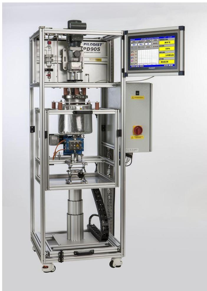
Система разработана для загрузки 1 – 2 L материала. Битум нагревают до 300 °C в сосуде из нержавеющей стали (1.4571) и обрабатывают изотермически сжатым воздухом. Сжатый воздух впрыскивается с помощью трубки с заранее определенной скоростью потока, при этом битум интенсивно перемешивают в сосуде с помощью механической мешалки высокой производительности.
