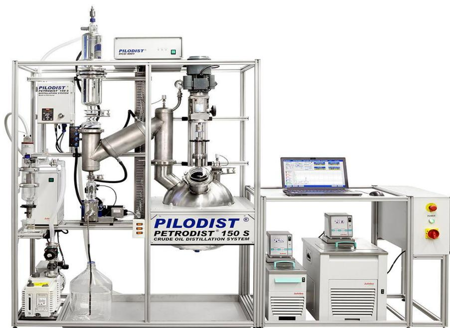
Управляемая система перегонки сырой нефти процесс включает в себя контроль нагрева и вакуума, а также отображение и хранение всех важных значений процесса: Конструкция основана на дистилляции заряда 10 - 20 кг сырой нефти за минимум времени с высокой пропускной способностью до конечной температуры 400 ° С АЕТ.
