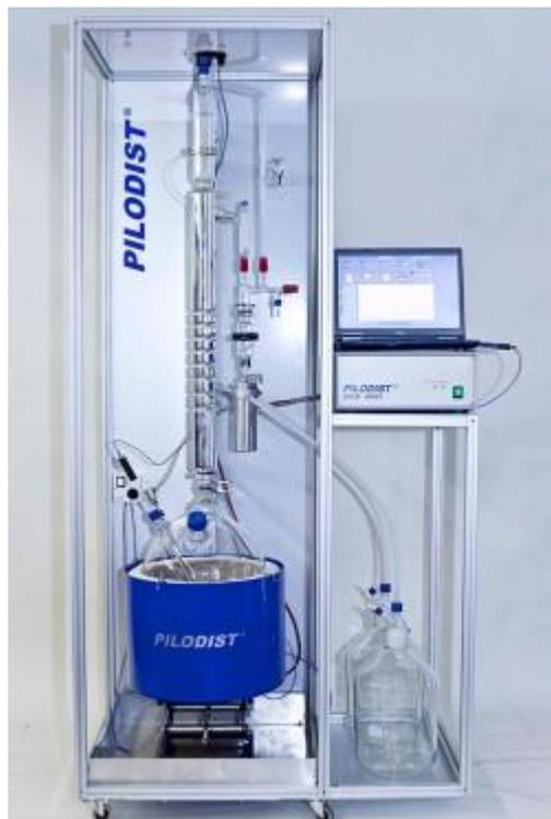
Блок рекуперации растворителей с трубкой для концентрации. (Concentric-Tube-Column).
