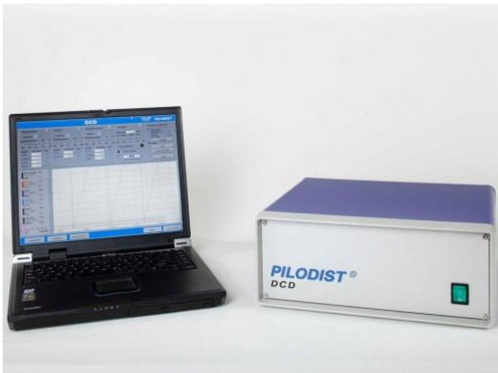
Управляемое компьютером устройство для систем дистилляции PILODIST. Для работы и контроля температуры, вакуума, делителя отлива, предела и систем аварийной сигнализации и дробного коллектора.
