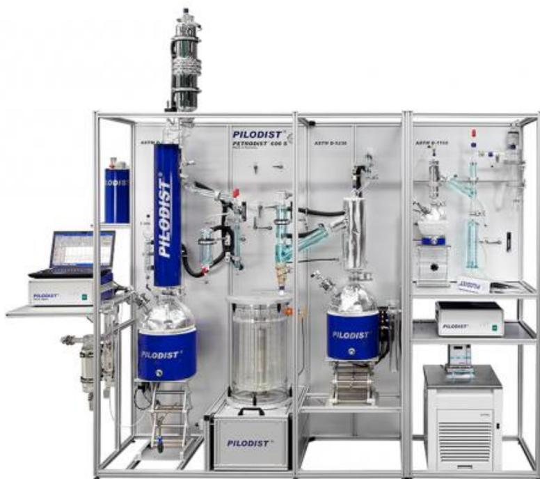
PETRODIST 600 S - это уникальная комбинированная установка, позволяющая проводить дистилляцию нефти и нефтепродуктов по трем независимым стандартным методикам ASTM. Установка состоит из трех модулей:
