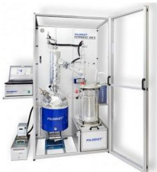
ПОЛУАВТОМАТИЧЕСКИЙ МЕТОД согласно ASTM D5236.
