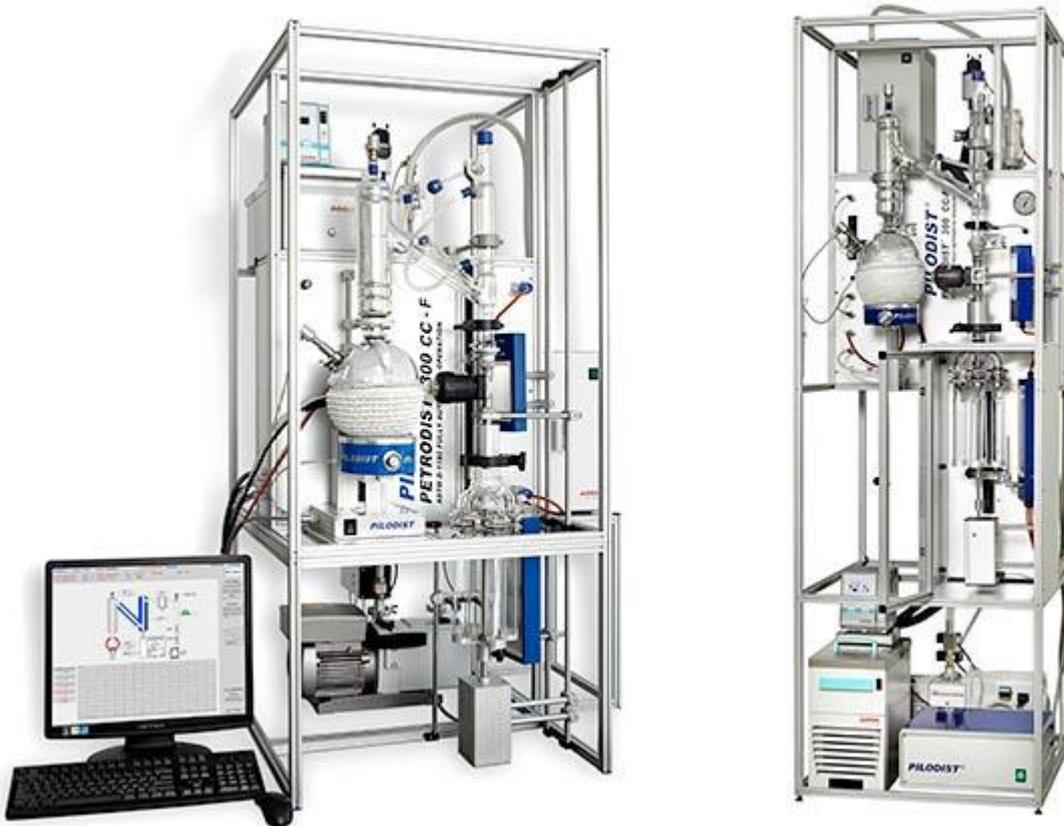
Полностью автоматическая система дистилляции сырой нефти, процесс контролируется в соответствии с документом ASTM D-1160, но с автоматическим дробным коллектором для определения интервалов кипения продуктов сырой нефти под вакуумом. Системой можно управлять в строгом соответствии с процедурой ASTM с 1 единственным получателем или альтернативно, при помощи автоматического дробного коллектора, с 4 получателями.
