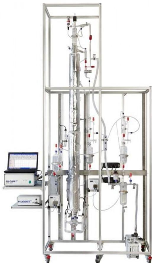
Система дистилляции на компьютерном управлении для непрерывной работы.
